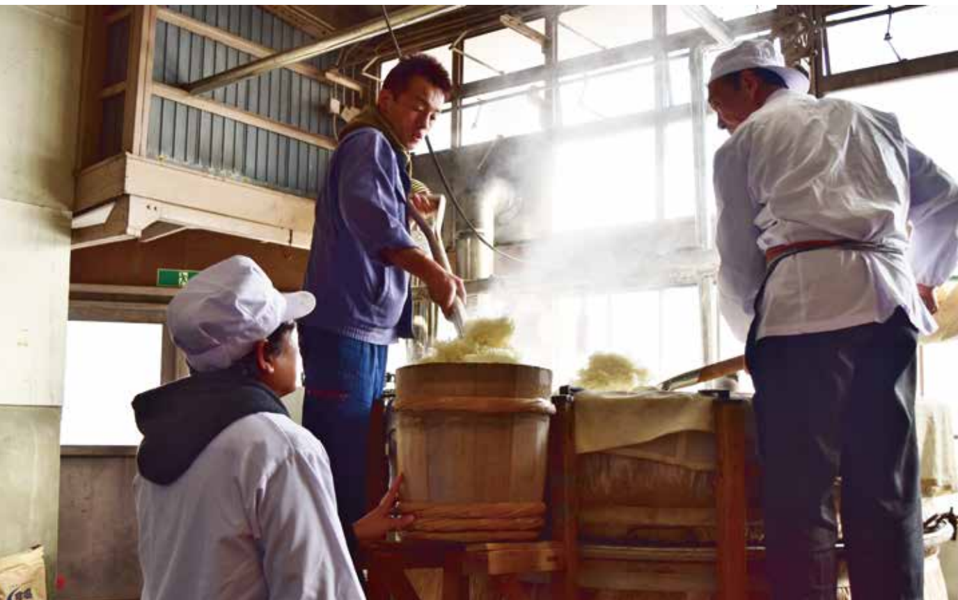
玄関を入るともうとうとう蒸気が上がる和釜。蒸されたばかりの酒米をスコップで掘り出す作業は重労働
