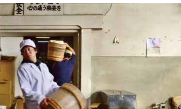
蒸し上がった米は木桶に入れ、蔵の奥にある放冷器まで何往復も担いで運ぶ
