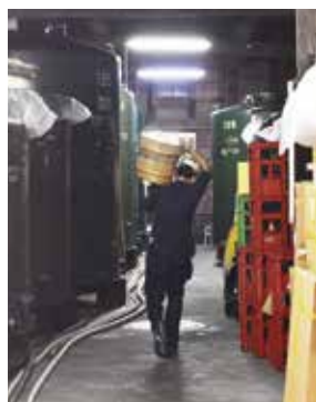
蒸し上がった米は木桶に入れ、蔵の奥にある放冷器まで何往復も担いで運ぶ
