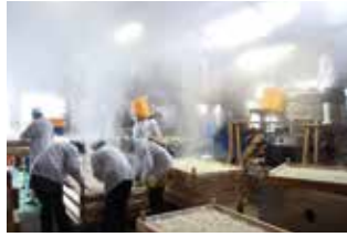
狭い蔵での作業を効率よくするために、オーダーで作った放冷箱
